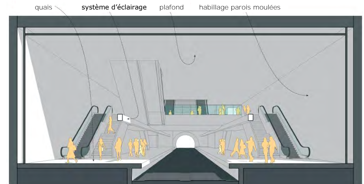
Coupe-type d'une station au niveau des quais
