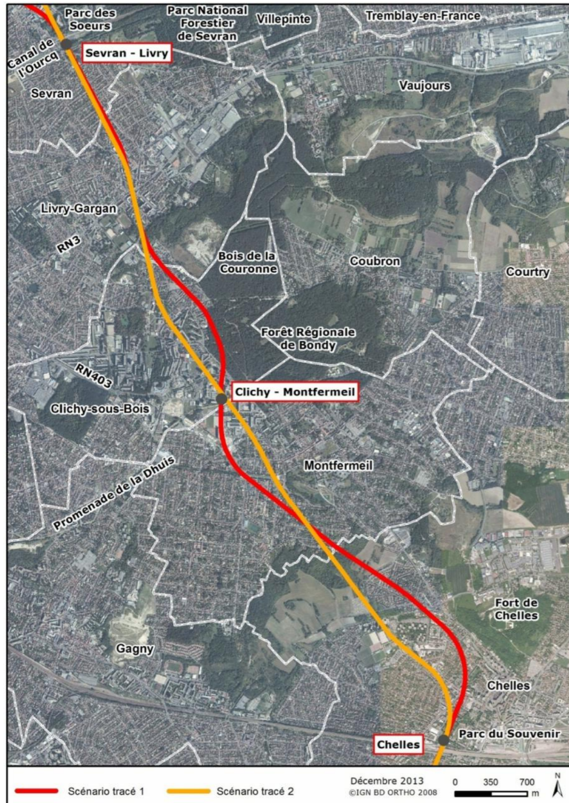
Figure 8 : Vues en plan du tracé de référence et de la solution retenue entre Chelles et Sevran – Livry
