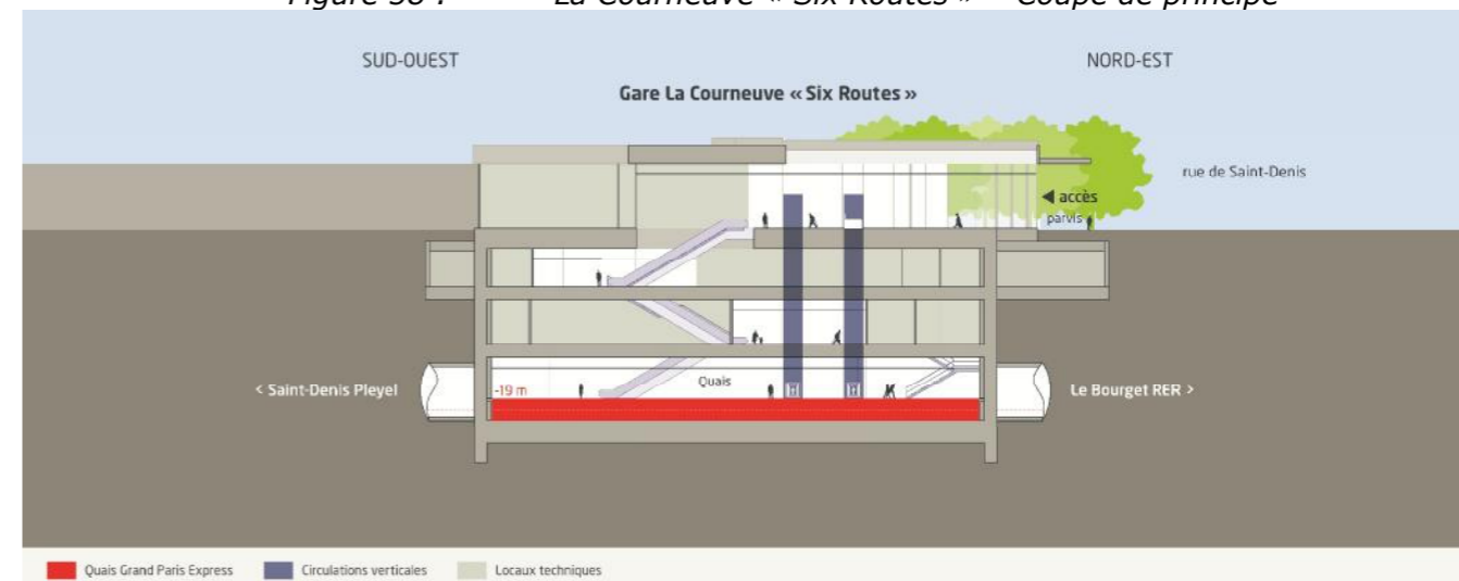
Figure 58 : La Courneuve « Six Routes » – Coupe de principe
