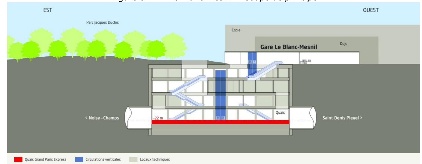
Figure 52 : Le Blanc-Mesnil – Coupe de principe
