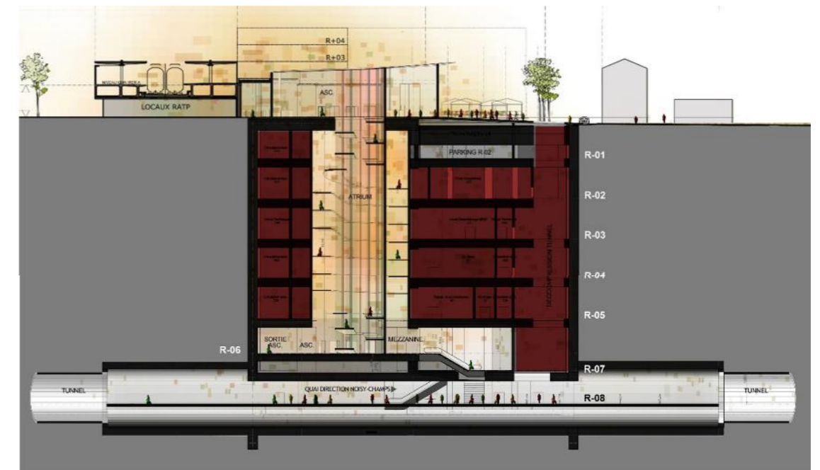
Figure 89 : Coupe longitudinale - Niveaux techniques en rouge
